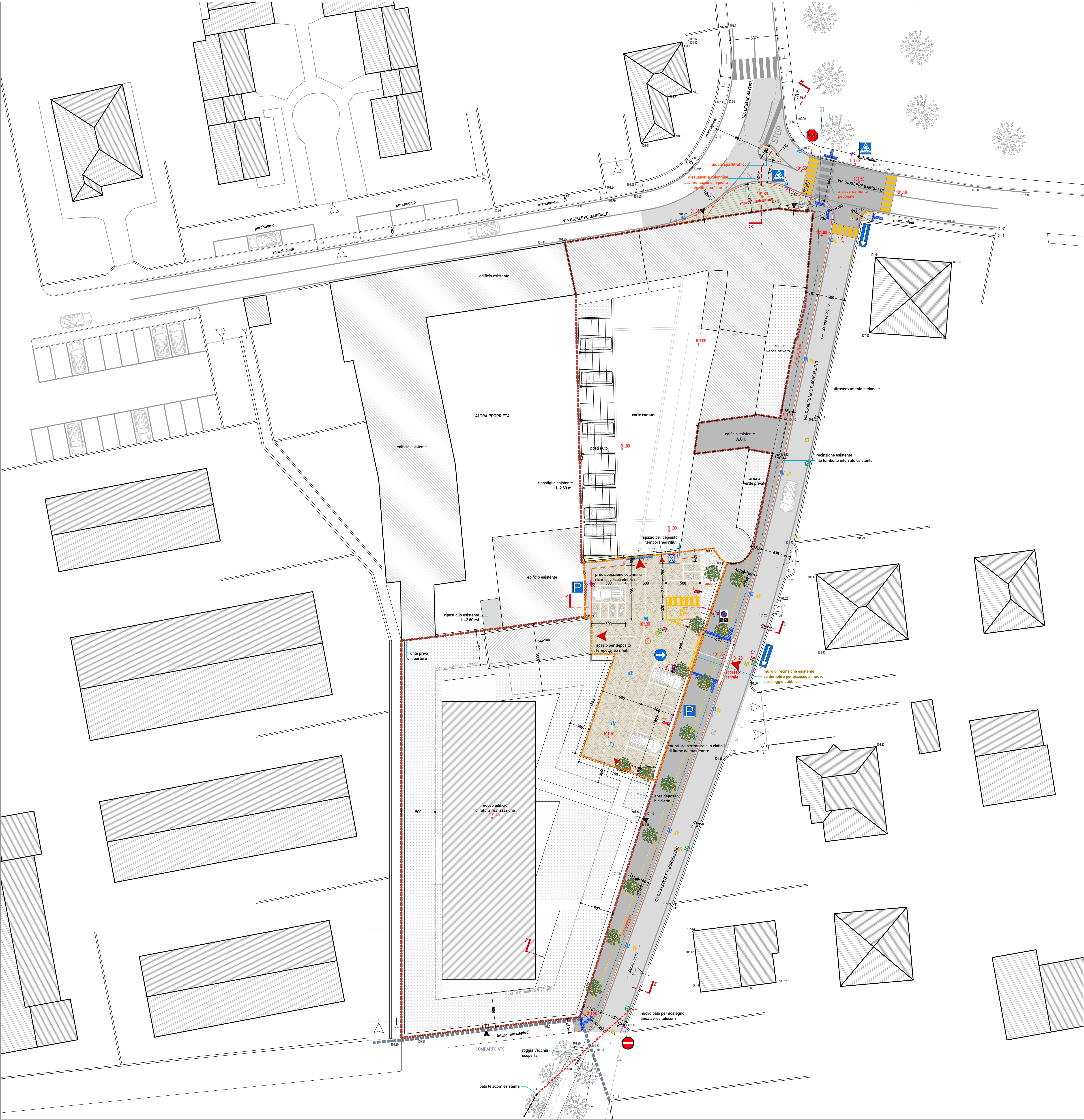
PLANIMETRIA GENERALE \ OPERE DI URBANIZZAZIONE-OPERE STRADALI \ scala 1:250
