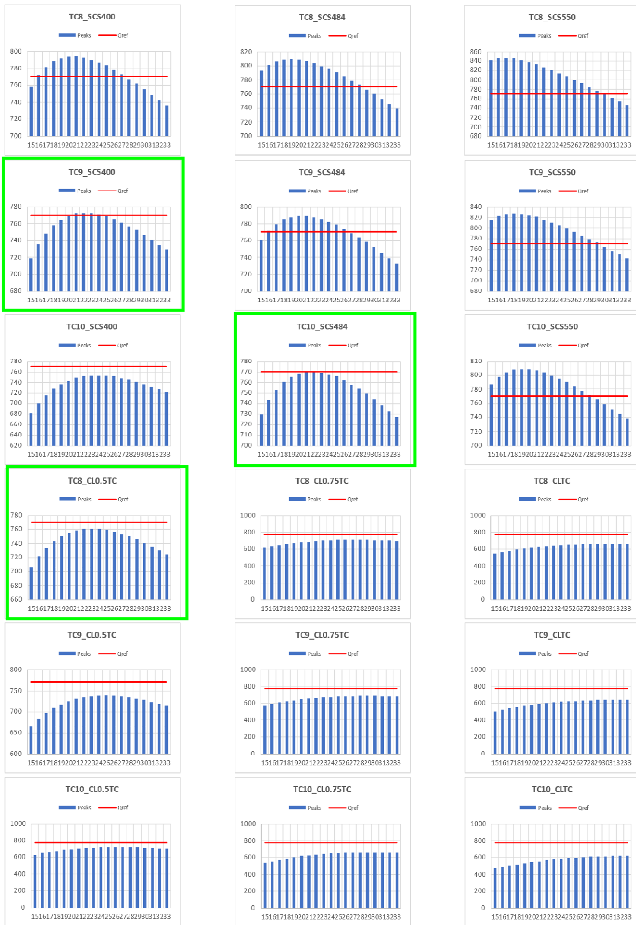
Fig. 24 – Confronto tra i valori al colmo del set di idrogrammi duecentennali di diversi scenari idrologici da idrogrammi rettangolari con il valore di 770 mc/s
