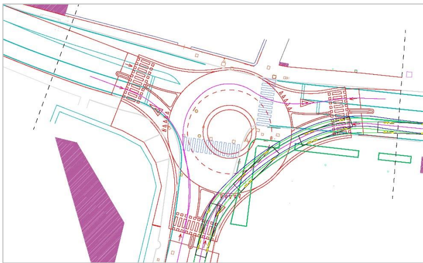
Figura 4.5.2 – Verifica svolta a sinistra da Via Paderno veicolo da 12 m
